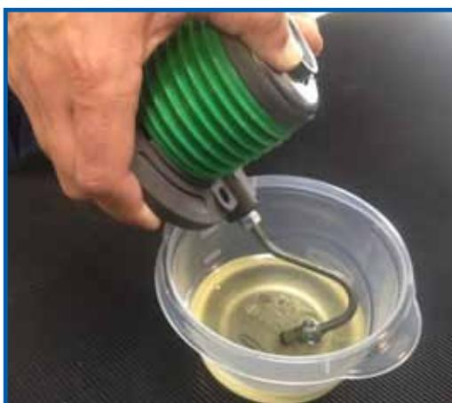
Paso 3: Comprimir lentamente el rodamiento hacia abajo liberando el aire del interior del cilindro auxiliar concéntrico; hasta que el rodamiento este totalmente comprimido. Asegúrese que la manguera de entrada debe permanecer completamente sumergida durante este proceso.
