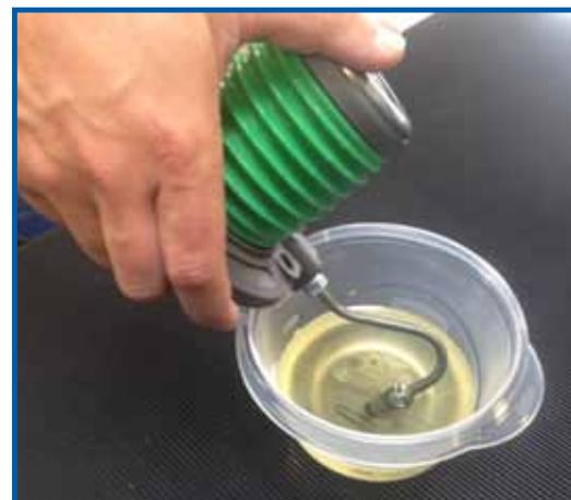
Paso 5: Repita el proceso 3 y 4 veces hasta que ya no se vea salida del aire por la manguera de alimentación (Al comprimir ya no salgan de la manguera de alimentación burbujas de aire). Estos dos procesos se pueden repetir varias veces hasta lograr la eliminación del aire del sistema.
